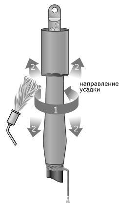
**Монтаж муфты завершен. Дайте муфте остыть прежде чем подвергать ее какому-либо механическому воздействию.**
